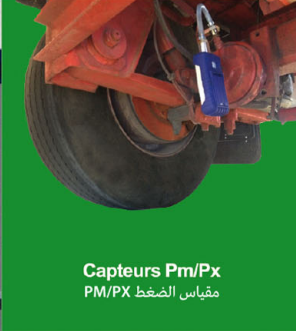
Simulation de charge par élévation des rouleaux محاكاة الحمل من خلال رفع سرير الإسطوانات
